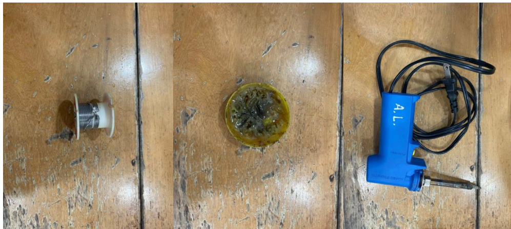
ตะกั่ว ไม้ยาประสาน หัวแร้งส์ จากห้องแลปสาขาวิศวกรรมศาสตร์ อิเล็กทรอนิกส์
